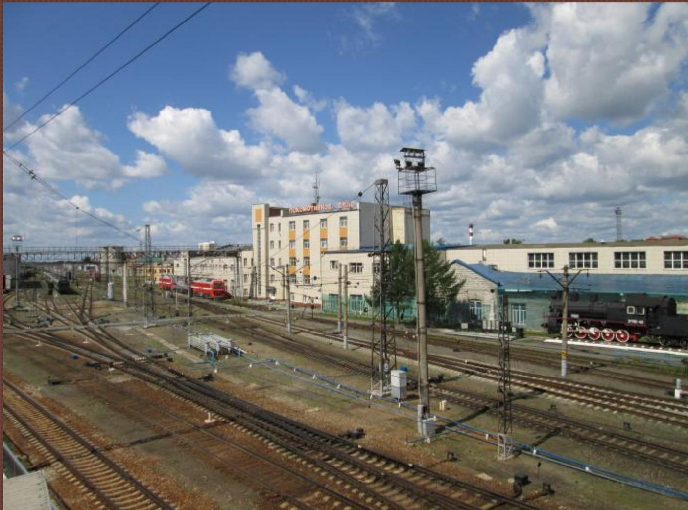
Локомотивное депо - сюда прибывают поезда после своей работы, здесь их осматривают, ремонтируют и приводят в рабочее состояние.
